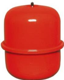
Le vase d'expansion permet de compenser la dilatation de l'eau dans le réseau chauffage due à l'élévation de la température. Il s'installe sur le retour chauffage pour éviter une température d'eau trop élevée sur la membrane.
